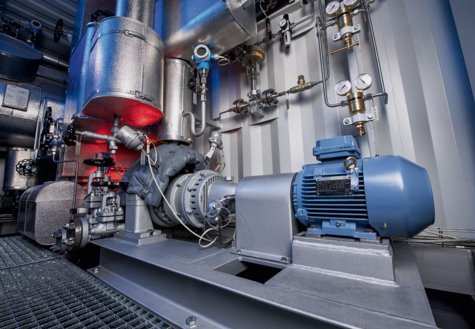
Die magnetgekuppelte, selbstentlüftende Pumpe arbeitet zuverlässig bei Temperaturen von bis zu 500 °C.
